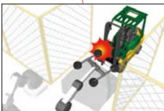
ライン稼働中と気付かずに、部材を投入する危険性あり。
