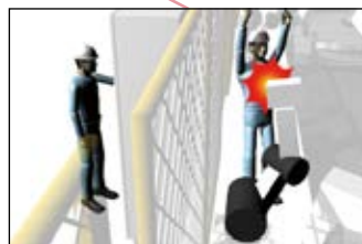
安全柵内に人がいるときに機械を起動させてしまう危険性あり。
