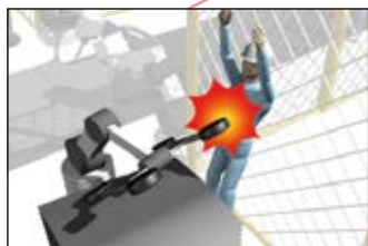
部材投入時などで、部材付近の人がロボットに挟まれる危険性あり。
