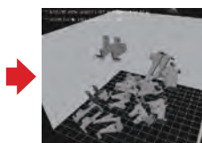
物理シミュレーションにより部品のバラ積み供給状態の再現
